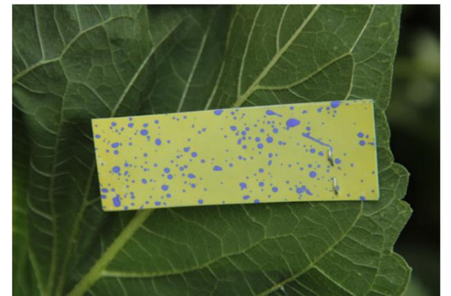
Качество покрытия нижней стороны листьев подсолнечника рабочим раствором при использовании Dropleg<sup>UL</sup>
