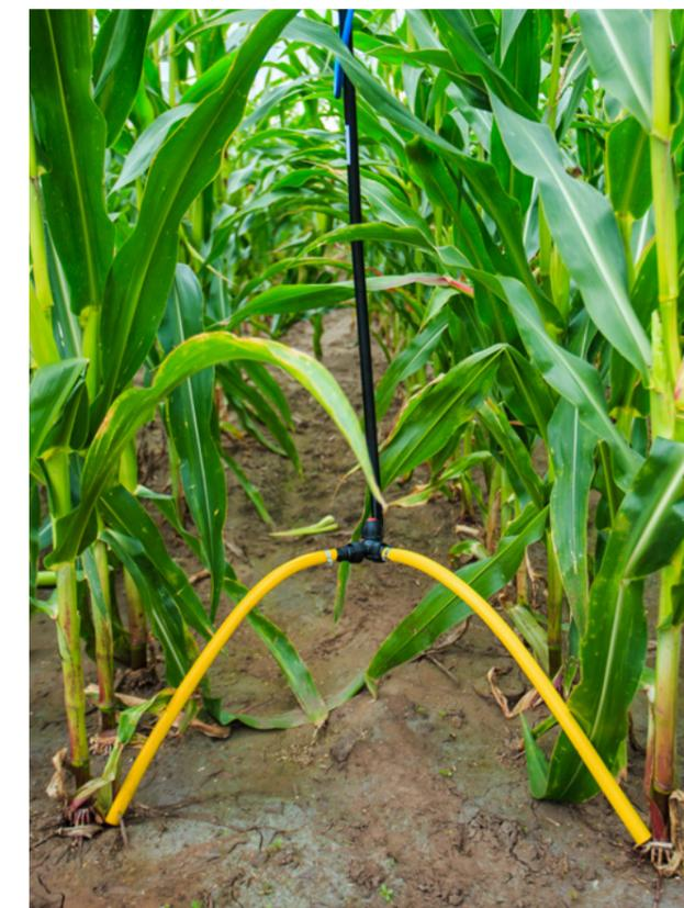
**Dropleg<sup>UL</sup>** в комбинации с пятиструйной форсункой используется для внесения КАС в фазу трубкования в зерновых колосовых.
