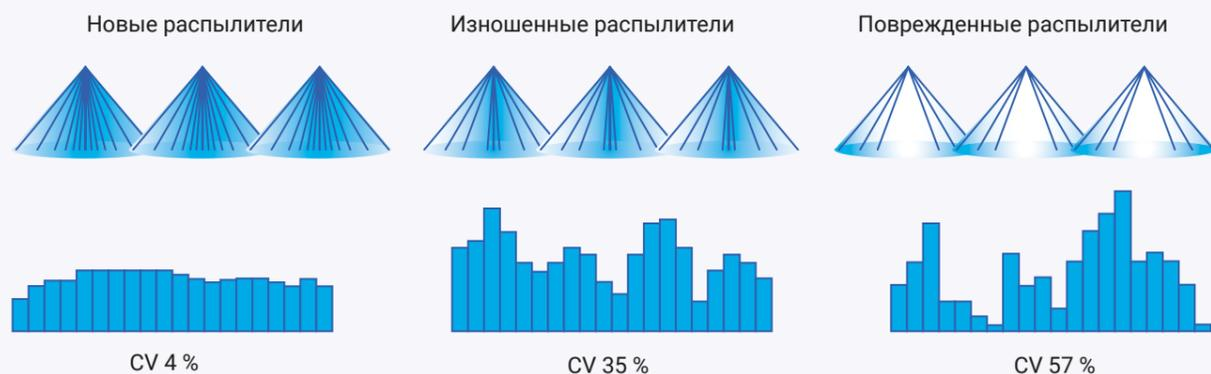
Износ отверстия форсунки приводит к неправильному распределению смеси. Коэффициент вариации (КВ) высокий.
