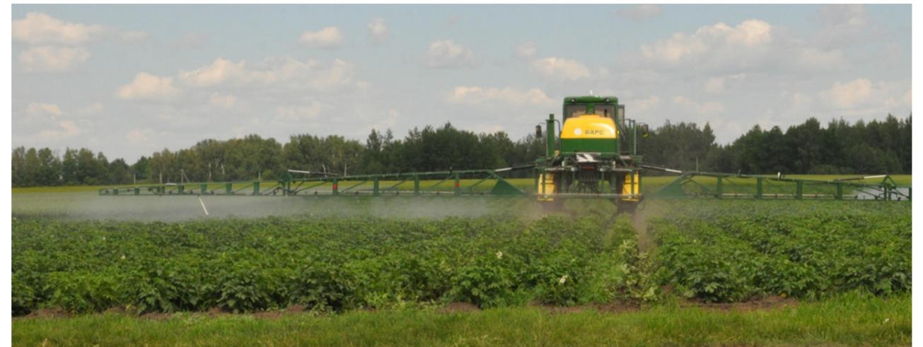
Снос при использовании разных типов форсунок. Слева на штанге щелевые форсунки ST со сносом, справа инжекторные IDKT без сноса рабочего раствора
