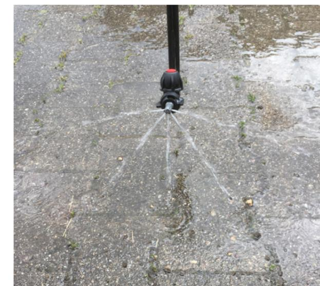
Эффективность многих СЗР зависит от качественного их распределения и его присутствия возле объекта, которого он контролирует. Обычными опрыскивателями такого результата невозможно достичь из-за архитектурной особенности растений, которая препятствует прямолинейному полету капель с форсунок. Листья формируют мертвые зоны для проникновения внутрь растений и к стеблям. Нижнюю же часть листьев невозможно обработать из-за особенности полета капель вертикально.
