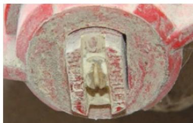
*"Закоксованный" распылитель – орпыскиватель не промыли после обработки фунгицидом.*
