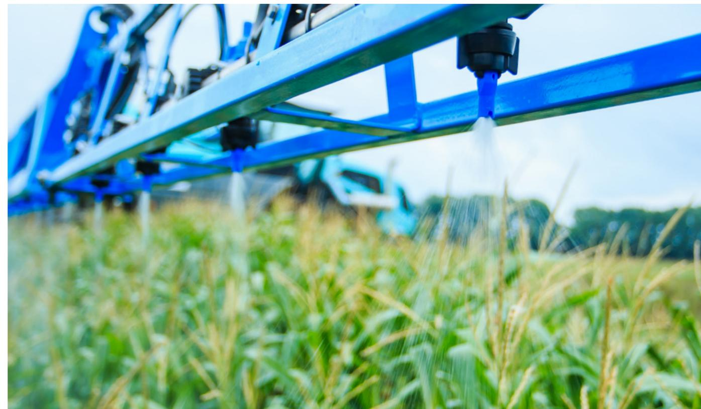
Однако полноформатный инжекторный распылитель стоит недешево, что для многих хозяйств часто является решающим фактором при выборе комплектующих для опрыскивателя. Он также требует высококачественной оснастки опрыскивателя, способной обеспечить диапазон рабочего давления от 2 до 8 бар.
