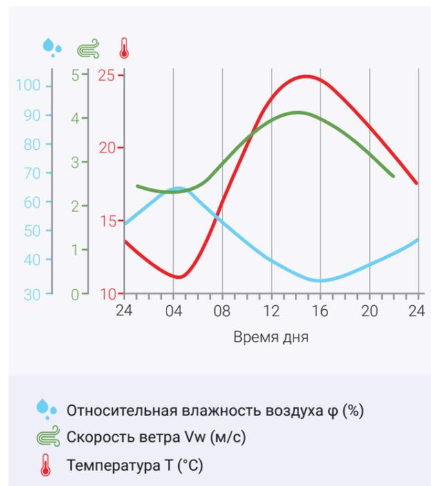
На графике показано изменение скорости ветра, температуры, влажности в течение дня. Самое неблагоприятное для опрыскивания время — с 13 до 17 часов из-за высокой температуры, низкой влажности или сильного ветра в это время суток.
