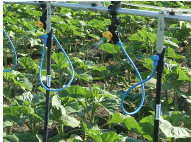
Работа форсунок на штанге опрыскивателя в комбинации с Dropleg<sup>UL</sup>
